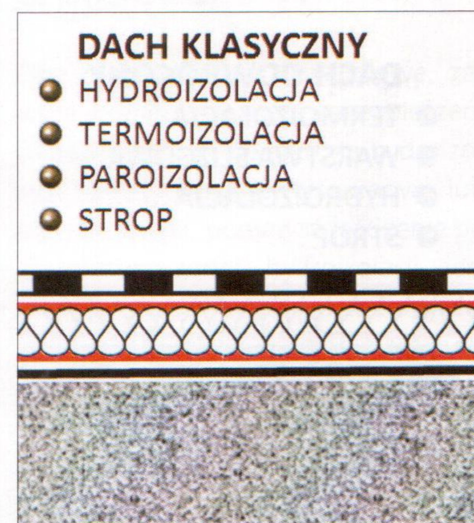
Rys. 1 | Przekrój dachu klasycznego
